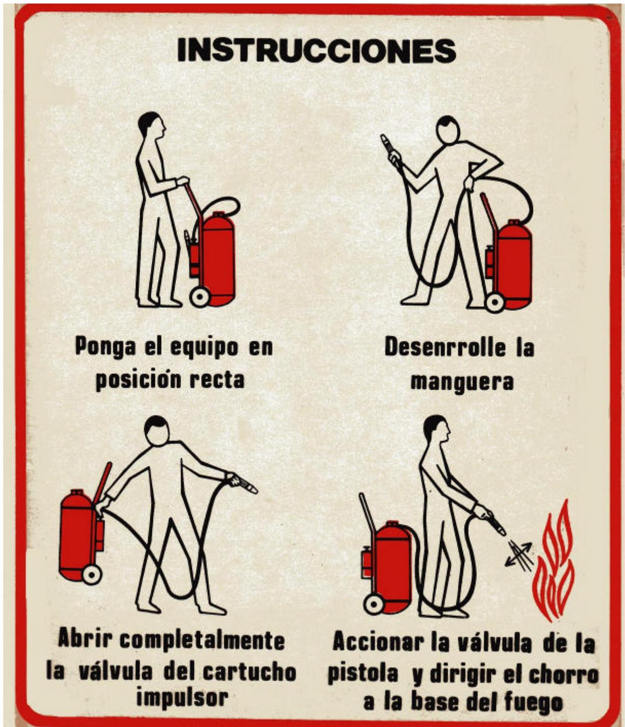
FIGURA 8 - Ejemplo de instrucciones de uso de extintor con cilindro impulsor
