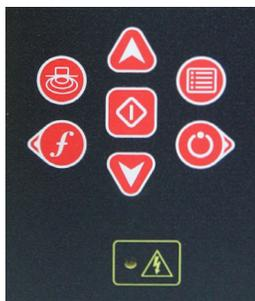
Figura 4 – LED Indicador de Alto Voltaje
