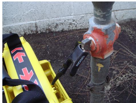
Figura 7 – Clip Conductor conectado al conductor objetivo
