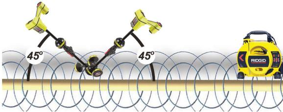
Figura 14 – Probando el Acoplamiento Aéreo
