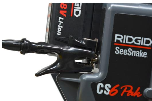
3. Encienda el transmisor y configure la frecuencia deseada. Para mejores resultados use frecuencias de 33 kHz y mayores. Encienda el receptor y configúrelo en la misma frecuencia que el transmisor.
