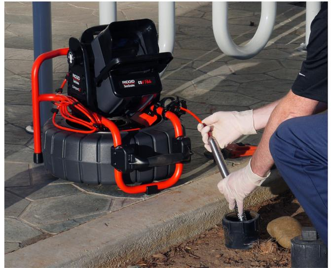
Si bien el CS6Pak puede conectarse con cualquier carrete de cámara de SeeSnake con el cable del sistema SeeSnake, se monta convenientemente en el sistema de anclaje del SeeSnake Compact2 para facilitar su visualización, una configuración rápida y su transporte.
