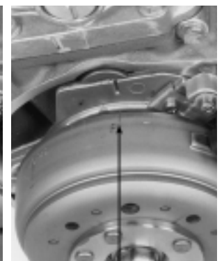
MARCAS DE AVANCE
