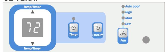
Nota: Presione o mantenga presionado el botón arriba (▲) o abajo (▼) hasta que la temperatura deseada se visualice en pantalla. Esta temperatura será automáticamente mantenida en cualquier lugar entre los 60°F (15°C) y 90°F (32°C). Si quiere que el visualizador muestre la temperatura actual de la habitación. Vea la sección "Operar Sólo el Ventilador" en la página 7.
