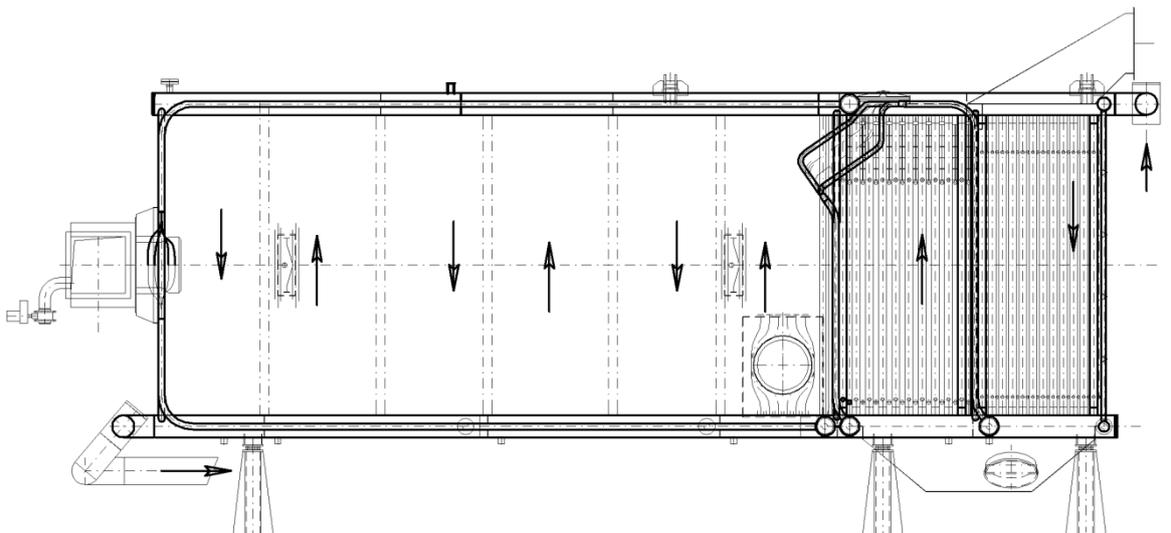
La primera parte de la caldera consiste en una enorme cámara de combustión, que está realizada como una membrana completamente refrigerada. En su pared frontal está ubicado el quemador de gas de emisiones bajas, el cual es alimentado desde el ventilador por los conductos de aire de combustión. Las dimensiones suficientes de la cámara de combustión, junto con el equipo de combustión adecuado, garantizan una combustión estable, con la producción de emisiones de CO y NOx bajas.
