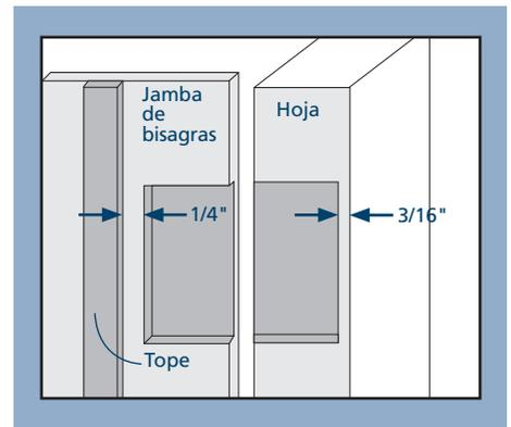
6. Usando una plantilla, marque las jambas y la hoja donde se montarán las bisagras. Usando un cincel o guía, muesque la jamba y la hoja para delinear las hojas de la bisagra sin ser más profundo que el grosor de las placas.
