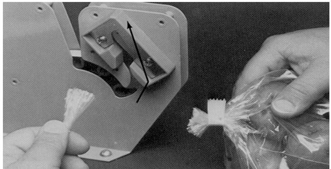
4.- Levantar la bolsa sellada de la cavidad en forma de V para cortar la cinta. Un movimiento rápido proveerá un mejor corte de la cinta. El bordeador eliminará el exceso de plástico del cuello de la bolsa.
