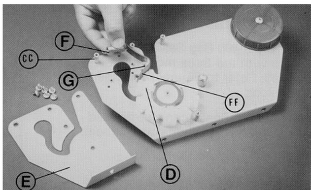
1.- Remover los 6 tornillos mostrados en la Figura, y retirar la cara E.
