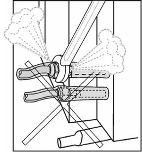
No destornille tubos de gas una vez instalados
