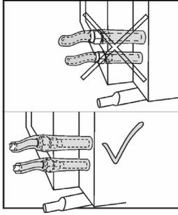
No deje descubiertas las tuercas de tubos de gas. Aísle las conexiones con el aislante de tubos suministrado
