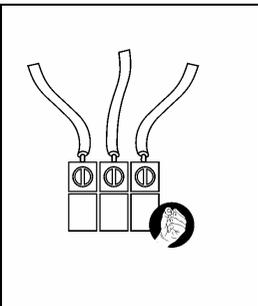
Tense cables de circuitos eléctricos
