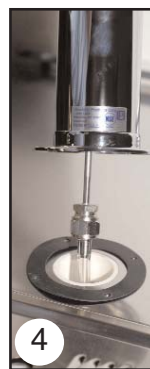
Atornille el conector de la línea de cerveza a la torre y asegúrela al gabinete con la arandela de goma debajo de la torre
