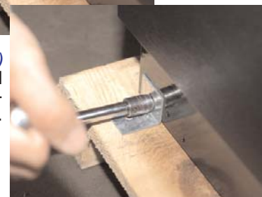
(figura 2) Removiendo el soporte del gabinete.
