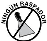
Para proteger las superficies de acero inoxidable, evite por completo el uso de compuestos de limpieza abrasivos, limpiadores a base de cloruro o limpiadores que contengan sales cuaternarias. **NUNCA** use ácido clorhídrico (ácido muriático) sobre acero inoxidable. **NUNCA** use cepillos metálicos ni esponjas o raspadores de metal.
