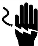
Para evitar LESIONES GRAVES, LA MUERTE O DAÑOS A LA PROPIEDAD, SIEMPRE bloquee o etiquete el panel del disyuntor hasta que el trabajo de mantenimiento se haya completado.
