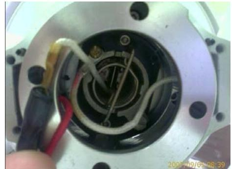
3. Quite el alambre que conecta la bombilla con el arnés de cableado "el alambre rojo". Substituya la bombilla por el número de parte P709 de la bombilla del reemplazo o similar. Lámpara del halógeno 12 voltios 55 vatios.
