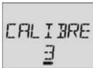
3. **AUTO-ZERO** parpadea mientras el detector pone automáticamente todos los sensores en cero y calibra el sensor de oxígeno. Si un sensor falla al realizar la puesta en cero automática, no se puede realizar su calibración. Una vez que se ha completado la puesta en cero automática, la pantalla LCD indica **GAS DE CAL**.
