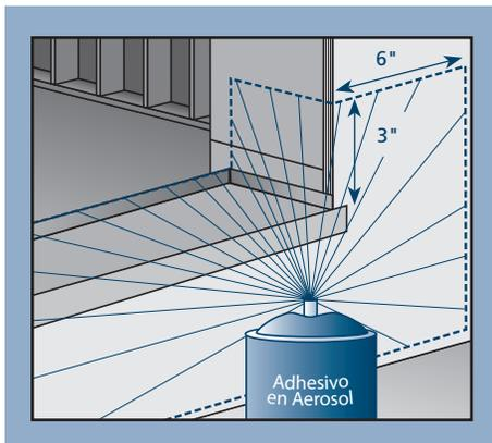
6. Corte una pieza de tapajuntas auto-adhesivo marca JELD-WEN del largo del umbral y colóquela sobre el umbral de charola tal como se muestra. El fondo del umbral de charola debe estar completamente cubierto por el tapajuntas auto-adhesivo. Para descansos con escalón, doble el tapajuntas hacia abajo tal como se muestra. Para losas continuas, córtelo a ras con la abertura en la pared.
