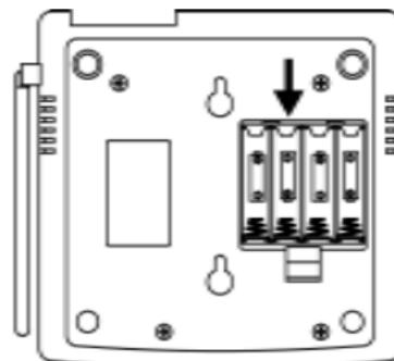
La **puerta del compartimiento de las baterías** está ubicada en la base del gabinete. Oprima la pestaña hacia abajo para abrir la puerta; instale las baterías siguiendo el diagrama de polaridad grabado en el gabinete.
