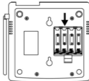
**La porte des piles** est située sur la base de l'enceinte. Appuyer vers le bas sur la languette pour ouvrir la porte; charger les piles selon le schéma de polarité gravé en relief sur l'enceinte.
