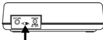
El **comutador AL / NI** está ubicado en la parte posterior del gabinete. Seleccione la posición del conmutador de acuerdo con el tipo de batería que vaya a usar.
