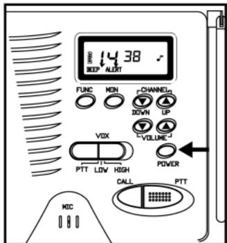
**Forma de Apagar la Estación - Oprima y mantenga OPRIMIDO el botón de apagado durante dos segundos.** Un tono sonará y la pantalla se apagará. El radio guardará automáticamente en memoria los ajustes corrientes de sus funciones.
