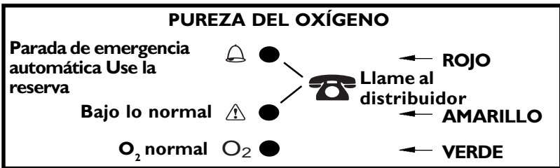
FIGURA 8 - PANEL DE CONTROL CON INDICADOR DE O 2
