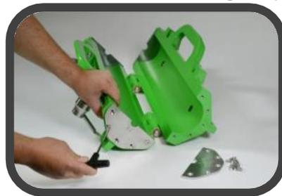
9. Montar las placas raspadoras a la unidad Viper usando los tornillos avellanados y la llave Allen suministrada. Nota: las placas raspadoras son de diferentes tamaños para adaptarse a la cuerda de alambre según la "Guía de selección de sellos y placas raspadoras".
