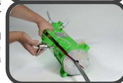
11. Sujetar el lubricador Viper con los sellos y raspadores equipados alrededor de la cuerda de alambre que va ser lubricada, apretar los dos tensores.
