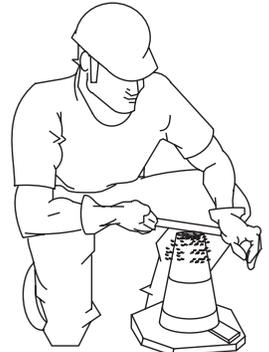
Figure 54-D. Prueba de asentamiento (Remover el exceso de concreto)
