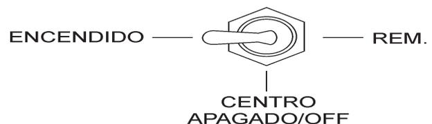
Figura 23. Interruptor de control de bombeo (On) (Encendido)
