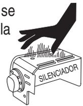
■ **Altas temperaturas** – Permita que el motor se enfríe, antes de agregar combustible ó darle servicio y mantenimiento. El contacto con componentes **¡calientes!** pueden causar serias quemaduras.
