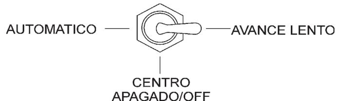
Figura 22. Interruptor de control de tiempo del cilindro (automático)
