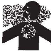
El humo del escape del motor diesel contiene gases tóxicos de monóxido de carbono. Este gas es incoloro e inodoro y puede causar la muerte si se inhala. **NUNCA** opere este equipo, en alguna área cerrada ó estrecha, donde el flujo de aire es restringido.
