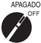
**SIEMPRE** coloque el interruptor del motor **ON/OFF (ENCENDIDO)** en la posición **OFF (APAGADO)**. **NUNCA** realice el mantenimiento de la unidad con la llave de ignición en la posición **ON (ENCENDIDO)**.
