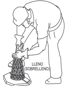
Figura 54-C. Prueba de asentamiento (Lleno completamente)
