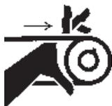
**NUNCA** coloque las manos ó los pies dentro de la **tolva**, mientras el motor este funcionando. **SIEMPRE** apague el motor, antes de realizar cualquier servicio de mantenimiento a la bomba.
