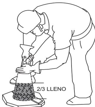
Figura 54-B. Prueba de asentamiento (2/3 lleno)
