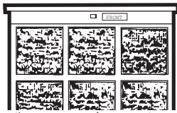
Filtre encrassé – Requiert un nettoyage
