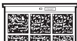
Filtro obstruido – reduce en gran parte el enfriamiento, la calefacción y el flujo del aire.
