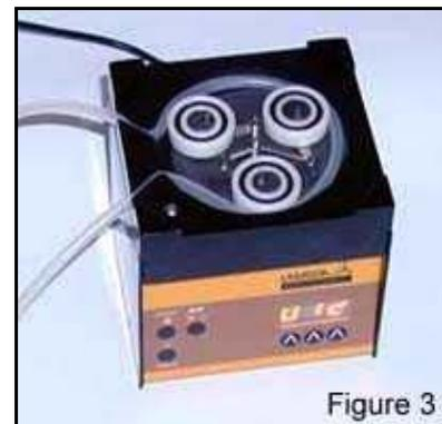
Fig. 3: Manguera / tubería en el cabezal
