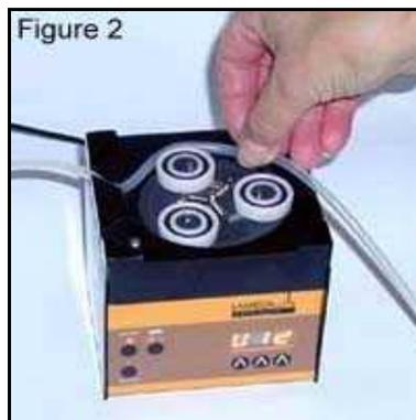
Fig. 2: Inserción de la manguera / tubería
