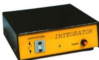
Los impulsos eléctricos que mueven el motor son registrados y transformados en corriente directa. El voltaje puede ser medido o archivado por registradores o voltímetros comunes. La interfaz RS-485 permite la conexi3n a una computadora (PC).
