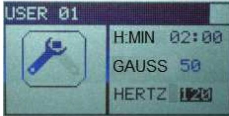
7. Utilice las teclas ▲ y ▼ para ajustar la frecuencia del tratamiento (de 0 a 120) y confirme la selección pulsando el botón OK. El dispositivo volverá a la pantalla del punto 6, resaltando el icono de la llave en el lado izquierdo de la pantalla. Pulse la tecla ▼ para resaltar el icono del imán;
