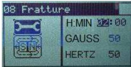
7. Pulse el botón ▼ hasta destacar el icono del imán en la parte inferior izquierda;
