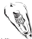
さらに、Fender Groove Tubesは、EL84 出力真空管をテストし、測定した性能を基に分類しています。分類された真空管は、1~10に細かくラベルされ、さらに大まかに青、白または赤に色分けされます。オリジナルの真空管と同じ細かなレーティング（および適用する場合は荒いレーティングも）を持つEL84 出力真空管のペアは、交換用として完璧です。ただし、オリジナルの真空管からレーティングが一段階しか違わない交換用真空管は、アンプを再バイアスせずにそのまま使えます。
