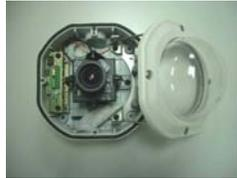
b. Ajuste el zoom y enfoque del lente (para modelos con lente vari-focal)
