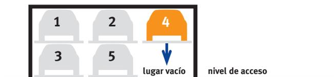
En el lugar vacío creado, la plataforma superior 4 baja automáticamente.
