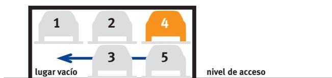
... escoja el lugar número 4 en el panel de control. Las plataformas 3 y 5 del nivel de acceso se desplazan automáticamente para la izquierda
