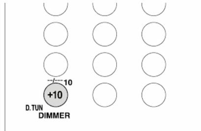
3. Introduzca la frecuencia de la emisora de radio en un máximo de 8 segundos usando los botones numéricos.
