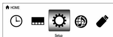
7. Seleccione “Setup” - “7.Hardware Setup” - “Firmware Update” - “Update via USB” con los cursores y, a continuación, pulse ENTER.
