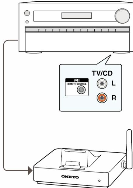
Conecte un componente Onkyo con conector RI a esta unidad usando un cable RI y un cable de audio analógico. Para más detalles, consulte el manual de instrucciones del componente con conector RI. El cable RI se puede conectar en cualquier orden. Cuando hay dos conectores RI, ambos trabajan de la misma manera y son intercambiables.
