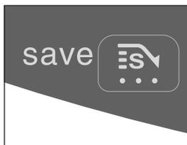
*I*: Cuando el piloto SAVE se ilumina, la estufa se encenderá y se apagará automáticamente, manteniendo la temperatura dentro de un determinado margen.
