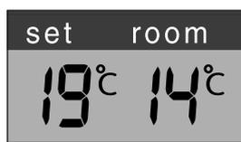
F: A la izquierda la temperatura deseada, a la derecha la temperatura existente
