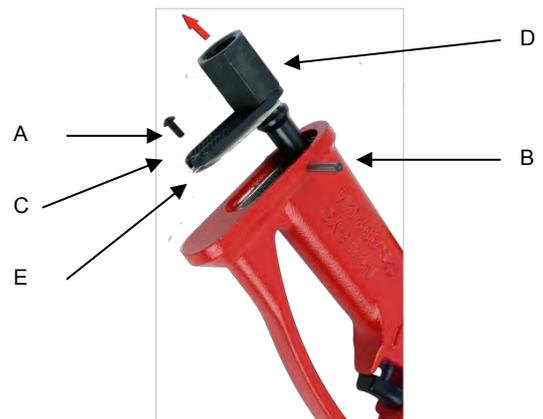
**ILUSTRACIÓN 14** – Sustitución Del Silenciador
