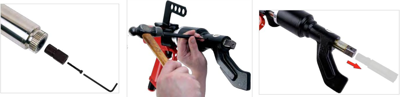
**ILUSTRACIÓN 15 – Sustitución Del Cuadro Transmisor**
