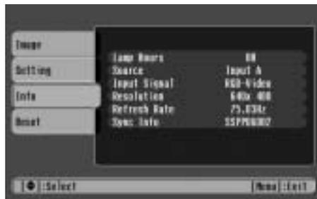
La vida útil de la lámpara es de 3000 horas si el modo de color está consistentemente configurado como **Negro cine**, y 2000 horas si se utiliza cualquier otro modo de color. Si la cifra que se muestra en pantalla está cerca al límite, tenga una lámpara de repuesto a la mano.
