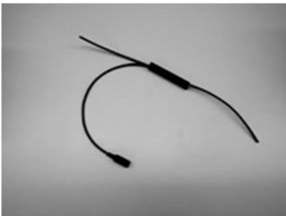
Corte un pedazo de aproximadamente 4 pulgadas del apretador, P/N 6601, métalo sobre los cables hasta su unión. Use una pistola de aire caliente o un pequeño encendedor de propano para apretar bien el material. Empiece del centro y aplique calor parejamente a través de todo el apretador. Trabaje bien las orillas. El pegamento de dentro del apretador hará que selle bien
