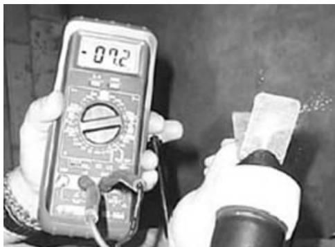
Vista de la correcta posición de la placa de metal en la aspersión y de la buena sujeción del cable de tierra. Esta aspersión esta midiendo una carga de 7.2  $\mu$ A
