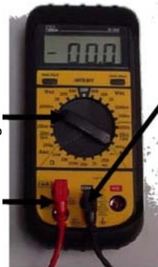
Conexión/cable de tierra puesto en el orificio indicado: "COM"
