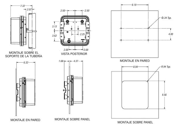
Montaje sobre Panel, Montaje Pared y Montaje sobre Tubería
