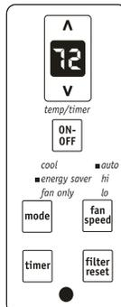
Nota: La unidad funcionará en modo de ahorro de energía cuando se utilice por primera vez. En este modo, el ventilador continuará funcionando durante 1 minuto después de que el compresor se cierre. Luego el ventilador realizará ciclos de 20 segundos con intervalos de 10 minutos cada uno hasta que la temperatura de la habitación supere la temperatura establecida, en ese momento, el compresor volverá a encenderse.
