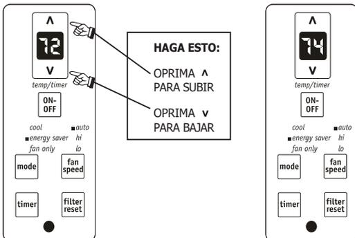
Nota: Pulse una vez o mantenga presionado tanto el botón arriba ( ^ ) como el botón abajo ( v ) hasta que se muestre la temperatura deseada en la pantalla. Esta temperatura se mantendrá automáticamente entre 60 °F (16 °C) y 90 °F (32 °C). Si quiere que la pantalla muestre la temperatura actual de la estancia, consulte la sección "Para operar sólo en modo ventilador" en la página 7.
