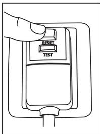
El cable de corriente contiene un dispositivo cortacorriente que detecta daños en el cable. Para comprobar su cable de corriente haga lo siguiente:
