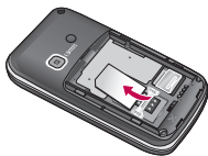
Rimozione scheda SIM
