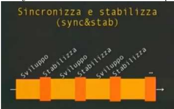
Esempio di modello incrementale . Modello usato in Microsoft: Sviluppo 4-8 settimane, stabilizzazione 2-4 settimane
