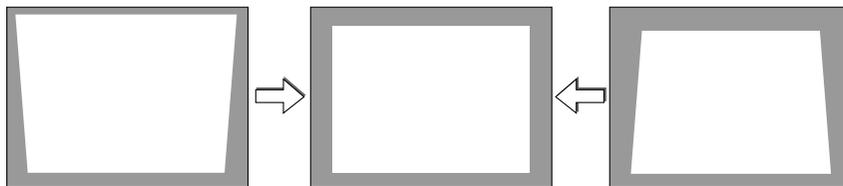
*NOTA: la correzione trapezoidale può comportare la visualizzazione di immagini sfocate, poiché la correzione viene eseguita elettronicamente.*
