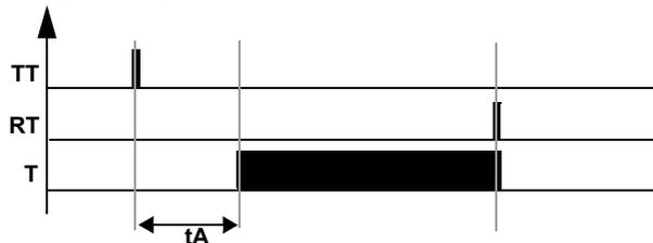
**Nota:** ogni impulso sull'ingresso TTx riavverte il valore corrente del temporizzatore.
