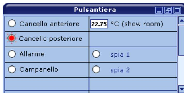
*Pulsantiera nella sezione Live. Si possono notare cinque spie spente, una accesa e il riquadro che indica in tempo reale il valore dell'ingresso analogico (temperatura della stanza).*
