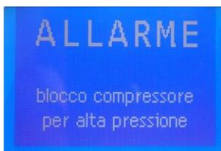
A sinistra una schermata di esempio di visualizzazione dell'allarme, in basso viene indicato l'apparecchio in allarme o il tipo di allarme; in questo esempio è in allarme il compressore per alta pressione
