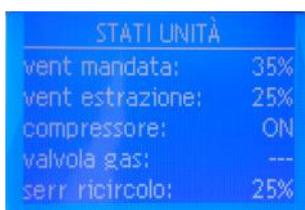
A sinistra la schermata degli stati unità, in questo caso vediamo che il ventilatore di mandata sta funzionando al 35%, il ventilatore di estrazione sta funzionando al 25%, il compressore è acceso, la valvola gas non è presente e la serranda di ricircolo è aperta al 25%.
