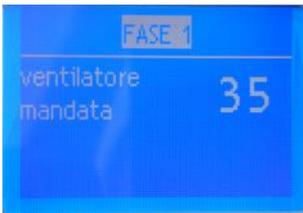
Siamo ora all'interno del menù di taratura come da immagine a sinistra, in alto viene indicata evidenziata la fase della taratura mentre sotto la linea vengono indicati i parametri da modificare, in questo caso c'è un solo parametro da modificare.
