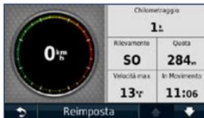
Il computer di viaggio indica la velocità corrente e fornisce informazioni sul viaggio. Per visualizzare il computer di viaggio, toccare il campo **Velocità** sulla mappa.
