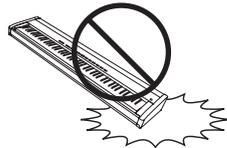
Lo strumento è pesante e necessita di 2 o più persone per lo spostamento. Trascinarlo può causargli delle rotture.
