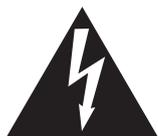
Il simbolo raffigurante un lampo all'interno di un triangolo, avverte della presenza, all'interno dei componenti dello strumento, di un "voltage pericoloso" di rilevanza tale da costituire rischio di scarica elettrica.
