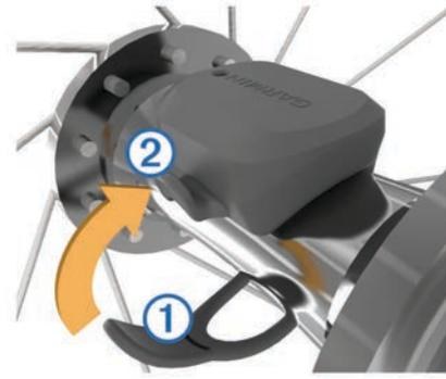
Il sensore può essere inclinato se installato su un mozzo asimmetrico. Ciò non influisce sul funzionamento.
