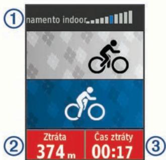
È possibile visualizzare il livello di resistenza ①, la distanza da percorrere o la distanza percorsa ② e il tempo rimanente o il tempo trascorso ③ rispetto alla distanza e al tempo inizialmente registrati per il percorso o l'attività.
