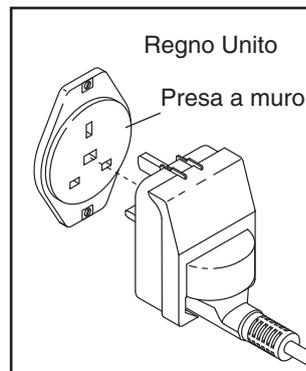
**⚠ PERICOLO:** un collegamento errato del conduttore di messa a terra può determinare un aumentato rischio di scosse elettriche. Verificare con un elettricista o tecnico qualificato in caso di dubbi relativi alla messa a terra del prodotto. Non modificare la spina in dotazione con il prodotto: qualora non si inserisca nella presa a muro, fare installare una presa adeguata da un elettricista qualificato.
