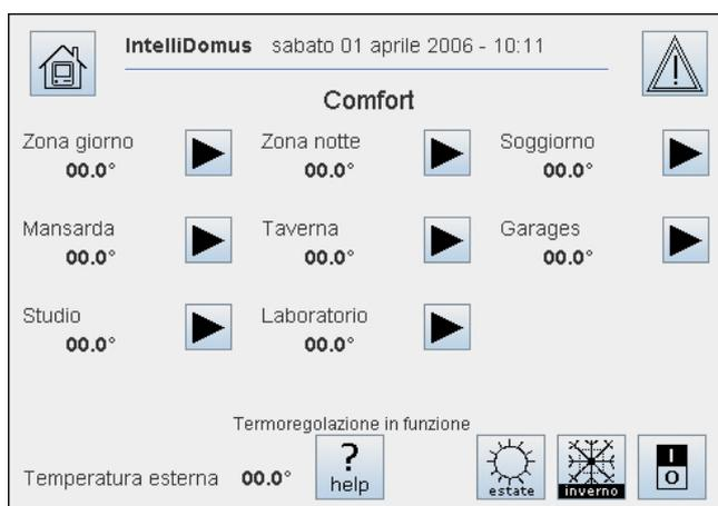
*Pulsante di funzionamento - modalità Estate* Premendolo si disabilita il suo complementare (Inverno) e si mette l'intero impianto in modalità di funzionamento "Estate", in tal modo il relè di attivazione della valvola di zona lavora in modo opposto rispetto al modo "Inverno", chiudendosi se la temperatura scende sotto al setpoint ed impedendo al fluido refrigerante di circolare ancora. Quando attivato la scritta "inverno" (rispettivamente per "estate") appare su sfondo nero.
