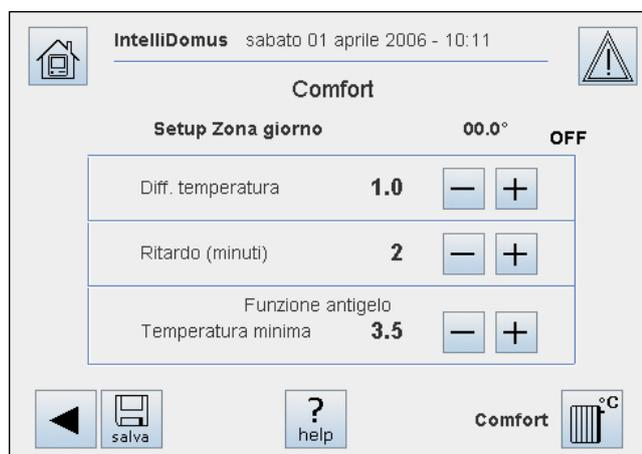
*Pulsante generico per incremento valore* Aumenta di 1 decimo di grado il valore del differenziale di temperatura o della temperatura minima per la funzionalità antigelo, mentre aumenta di 1 minuto il parametro ritardo.
