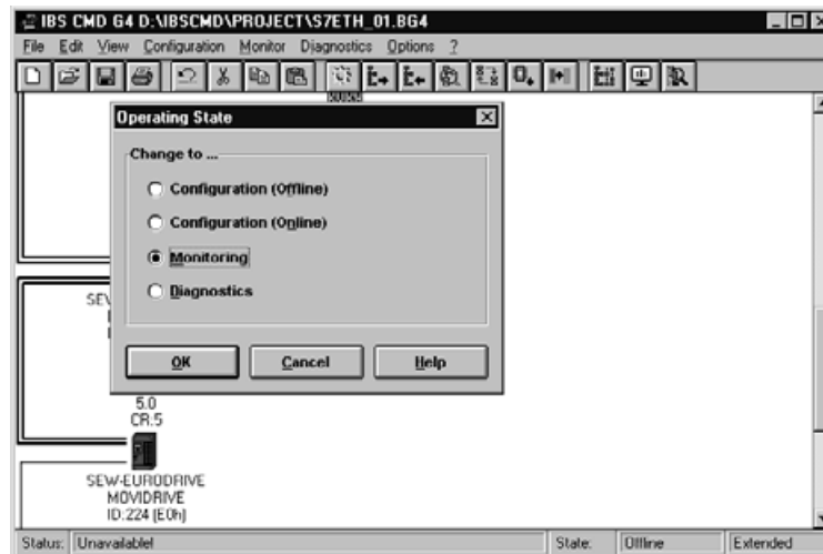
Fig. 62: Commutazione del programma CMD in modalità "MONITORING"
