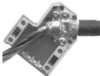
Fig. 32: Collegare lo schermo al connettore Sub-D
