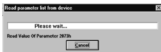
Fig. 65: Lettura dei parametri dispositivo da programma CMD, ovvero comunicazione PCP ok
