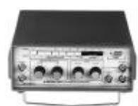
Tipo di segnale Sinusoidale, quadrato, triangolare, TTL
