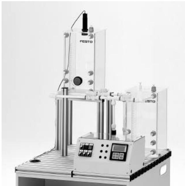
Assemblata, con Controllore Bürkert, Interfaccia RS 232 e PROFIBUS-FMS
