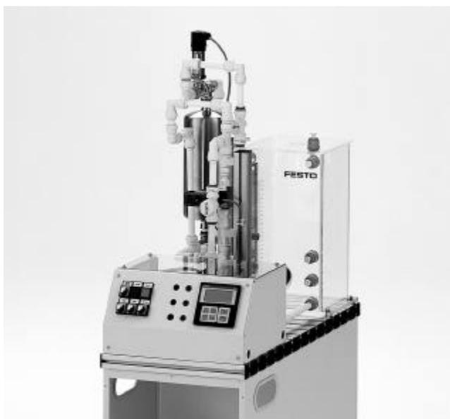
Assemblata, con Controllore Bürkert, Interfaccia RS 232 e PROFIBUS-FMS
