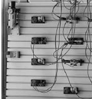
Il pannello profilato universale, è la piattaforma di base per tutti i pacchetti didattici. Su di esso si potranno montare i componenti dei kit per tutte le tecnologie previste. I componenti dei vari kit, sono collegabili con quelli degli altri - dai pacchetti di base fino a quelli avanzati
