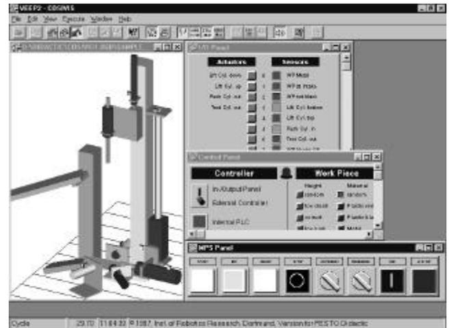
Nella pratica, i sistemi di visualizzazione di processo sono utilizzati per fornire una supervisione del flusso dei materiali e per offrire all'operatore una visione più completa dei segnali e degli stati dell'automatismo. Sono particolarmente efficaci per poter gestire processi fisicamente separati, e per fornire ai manutentori uno strumento efficace nella diagnostica degli errori.
