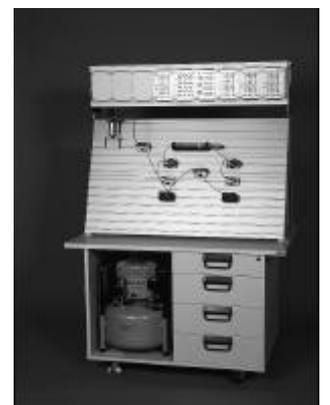
Posto di lavoro mobile, con accesso da un solo lato, contenitori, compressore d'aria, e pannello profilato inclinato
