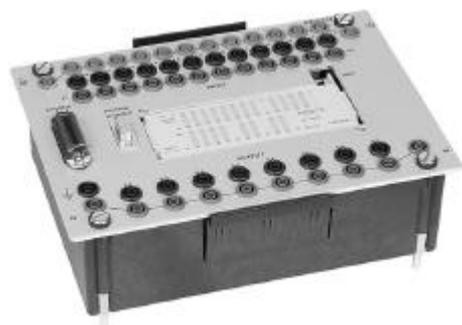
Il FEC è un PLC compatto e potente, adattabile alle applicazioni industriali, facile e veloce da installare. Questo controllore compatto in configurazione industriale con 12 ingressi digitali e 8 uscite a relè digitali offre tutte le funzioni richieste per automazioni con pochi I/O. Lo stato di ingressi e uscite è mostrato tramite LED. Il FEC FST può essere programmato con la lista istruzioni (AWL) e lo schema a contatti (KOP), ed il FEC IEC può essere programmato con ISaGRAF per IEC 1131-3.
