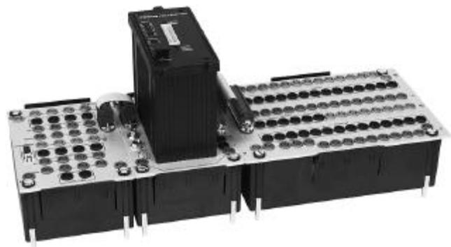
Oltre ai 21 ingressi digitali e 14 uscite digitali offerti dal 101-B, l' FPC 101 AF offre in più altri 8 ingressi analogici e 2 uscite analogiche. Con un'interfaccia seriale aggiuntiva per funzioni di controllo e visualizzazione, il 101 AF è stato a lungo il controllore Festo universale per molte applicazioni. Insieme ad una unità di connessione analogica e digitale FPC 101, questo controllore valorizza l'FPC EduTrainer 101 AF.
