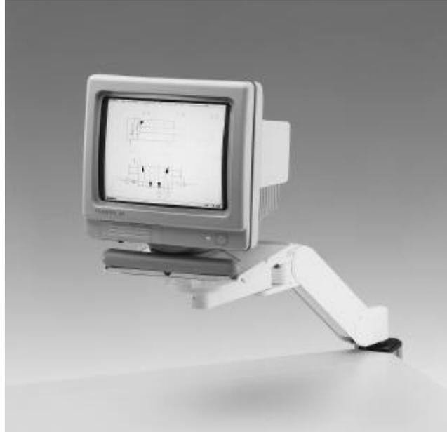
Il braccio girevole del monitor è attaccato alla colonna verticale di sostegno ed è regolabile in altezza. Il carico massimo è di 15 kg, la lunghezza del braccio girevole è 500 mm.
