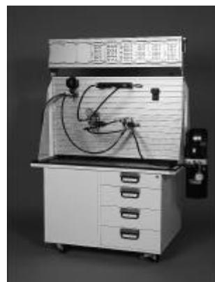
Posto di lavoro mobile, con accesso da entrambi i lati, due contenitori, pannelli profilati verticali, centralina idraulica e vaschetta per l'olio.
