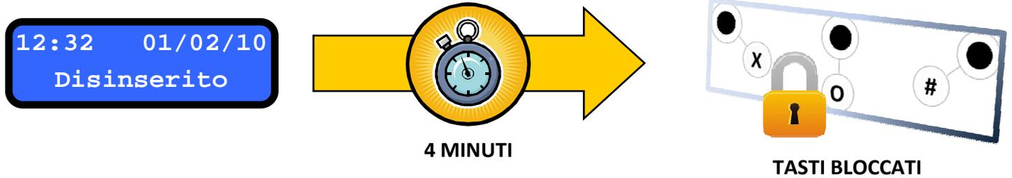
Per riattivare nuovamente i tasti è sufficiente effettuare una manovra di DISINSERIMENTO della centrale con un radiocomando o altro attivatore.
