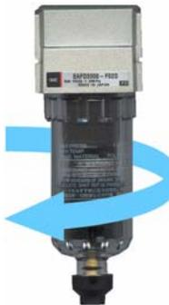
fig. 12 Rimozione tazza filtro aria
