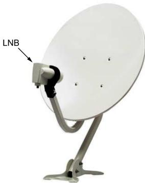
Il convertitore LNB (Low Noise Block, blocco a basso rumore) consente di amplificare e convertire i segnali di banda larga con frequenze relativamente alte in segnali analoghi ma con una frequenza notevolmente più bassa, definita Frequenza Intermedia (IF).
