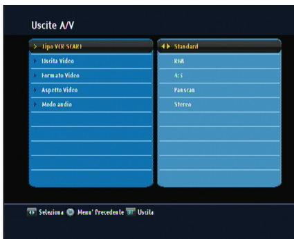
È necessario configurare le impostazioni video e audio in modo appropriato per il televisore e le altre apparecchiature in uso. Scegliere il menu **Impostazioni Sistema > Uscita A/V**. Viene visualizzata una schermata come quella nella figura a sinistra.
