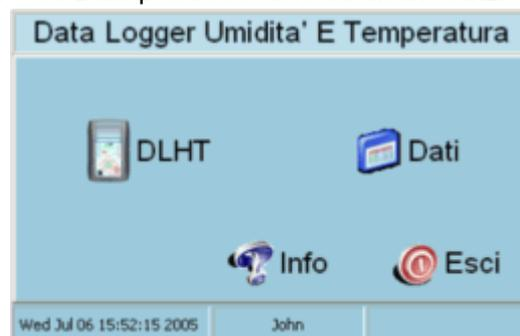
Nella parte inferiore della finestra si trovano tre riquadri: nel primo viene mostrata la data e l'ora (quest'ultima è riferita al GMT), nel secondo il nome dell'*Utente* attualmente attivo e nel terzo il numero di serie dell'unità collegata, se ve ne è una collegata.
