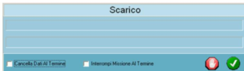
Completata l'operazione, comparirà un messaggio che attesta il buon esito del download dei dati. Qualora sia la prima volta che scaricate i dati da questo *DLHT*, oppure sono stati modificati alcuni parametri (come ad esempio la *Descrizione*) del *DLHT* collegato, prima della finestra recedente, potrebbe comparire uno dei due seguenti messaggi: *DLHT Aggiunto Al Database* o *Aggiornato DLHT Nel Database*.
