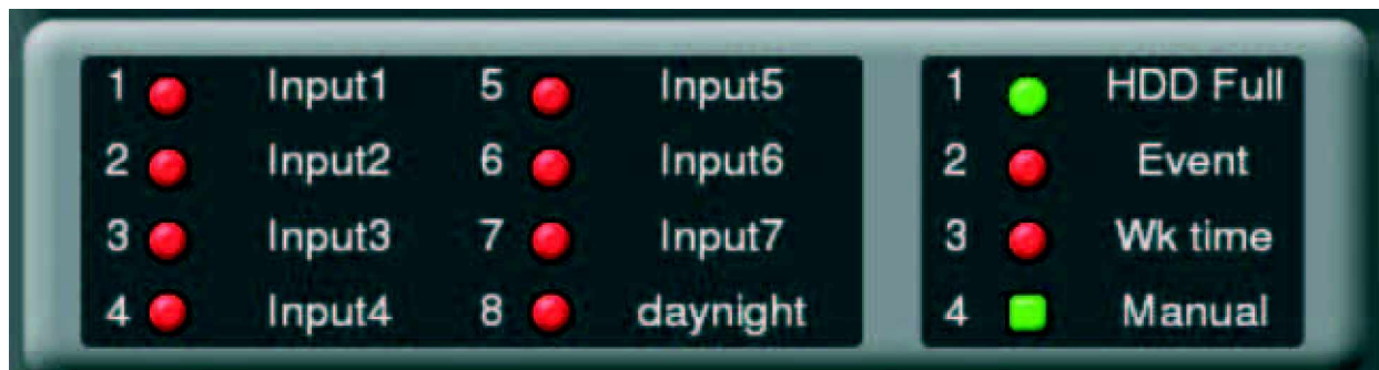
Fig. 9 - Pannello degli ingressi ed uscite
