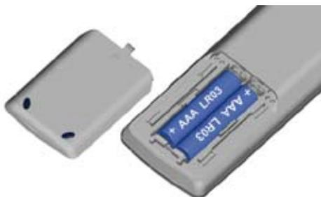
Per inserire o sostituire le batterie premere nel punto in cui è stampata la freccia. Far scorrere verso il basso il coperchio dell'alloggiamento delle batterie e rimuoverlo. Inserire batterie alcaline al manganese del tipo LR 03 (AAA), assicurandosi che i simboli + o - si trovino in posizione corretta. Quindi inserire nuovamente il coperchio dal basso.
